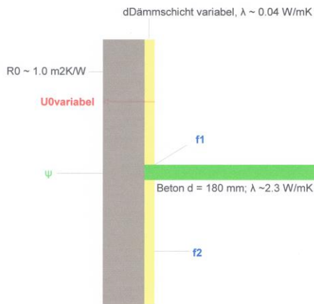
Bild 1: Schemaschnitt Wärmebrücke mit Festlegungen
